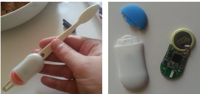
A gauche, une brosse à dent équipée d'un Cookie. A droite, un Cookie décortiqué.
