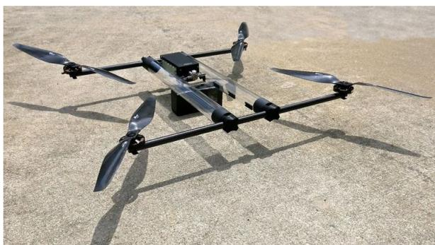
Ce drone quadricoptère nommé Hycopter est alimenté par une pile à combustible qui lui confère une autonomie de vol théorique de quatre heures. Le prototype est en cours de développement. Un premier vol d'essai est prévu cette année. © Horizon Energy Systems
